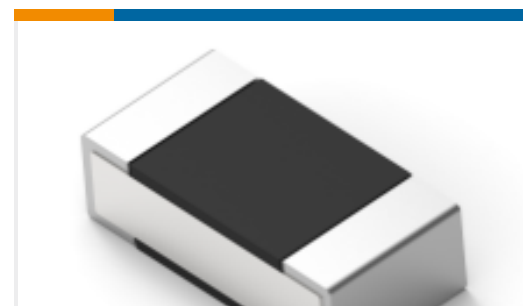
TE Part #9-2176307-8 RP 1E 0.1W 127K 0.1% 25PPM 5K RL
