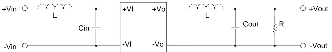
①对于纹波噪声要求较高的场合应外接 LC 滤波电路。
