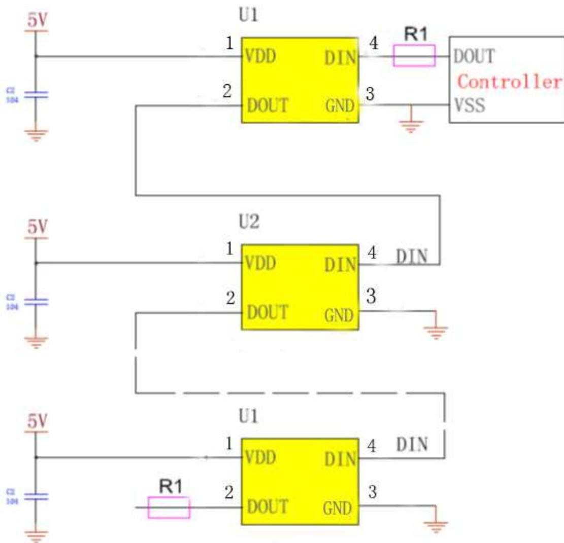
在实际应用电路中，为防止产品在测试时带电插拔产生的瞬间高压损伤IC内部信号输入输出引脚，应在信号输入及输出端串接保护电阻。此外，为了使各IC芯片间更稳定工作，各灯珠间的退偶电容则必不可少；
