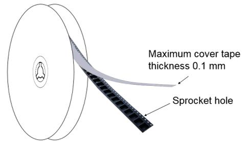
Figure 18. 13" reel dimension values (mm)
